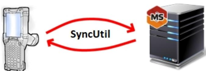
Утилита обмена (она же Cleverence.Synchronizer.exe) предназначена для отправки файлов данных из базы Mobile SMARTS на ТСД (на ОС Android, Win CE/ Mobile). Используется в том случае, если нет возможности подключиться к Wi-Fi, но нужны преимущества серверной базы.
