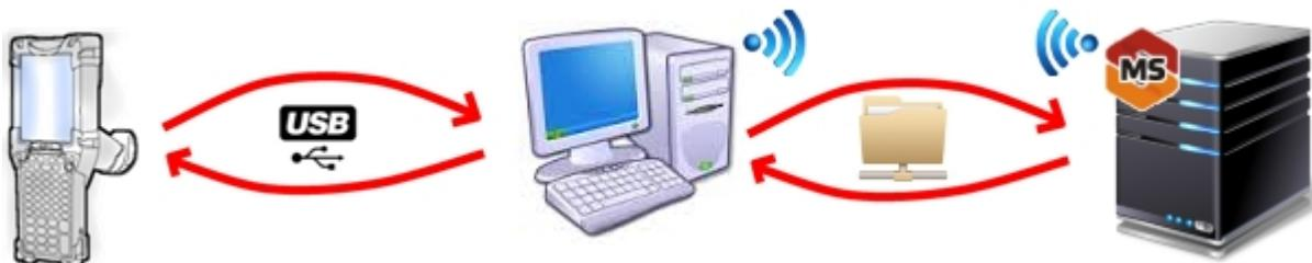
Обмен данными в RDP режиме происходит между учетной системой и ТСД уже не напрямую, а через сетевую папку обмена. Обязательно должен быть удаленный доступ по сети к компьютеру с установленной учетной системой и Mobile SMARTS.
