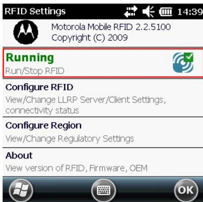
Кроме включения RFID, необходимо еще настроить порт. Выбираем «Configure RFID» и проверяем, что там указано 5084. Если указано другое, то вписываем порт 5084. Нажимаем «OK», для сохранения настройки порта.
