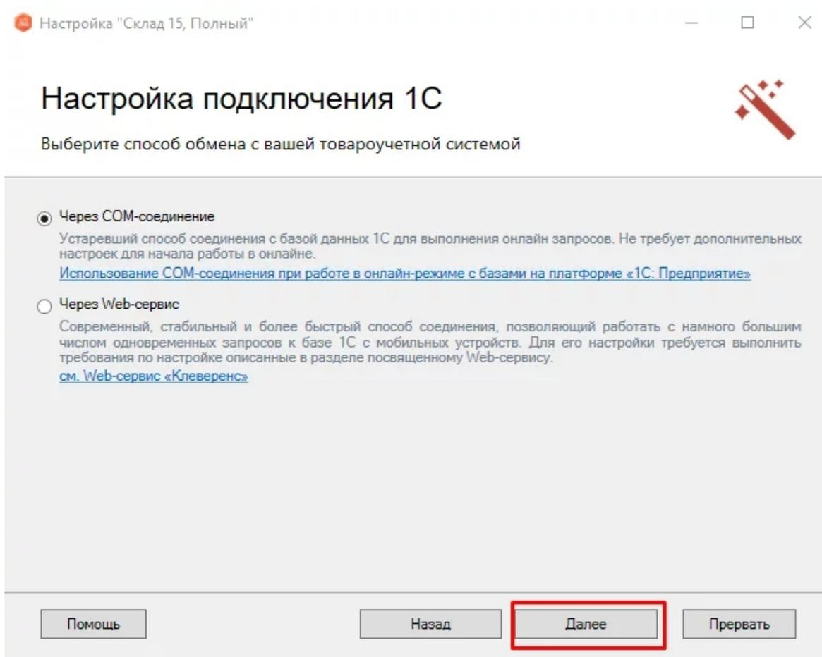
Для работы с учетной системой через COM-соединение в системе должен быть зарегистрирован COM-коннектор 1С, поэтому в следующем окне потребуется указать правильную версию этого коннектора (зависит от версии базы учетной системы, к которой происходит подключение, версии сервера, или версии остальных клиентов файловой базы системы). Если ни один коннектор не зарегистрирован, то **автоматически регистрируется** коннектор самой последней версии учетной системы (1С, SAP, Ахарта и др.).
