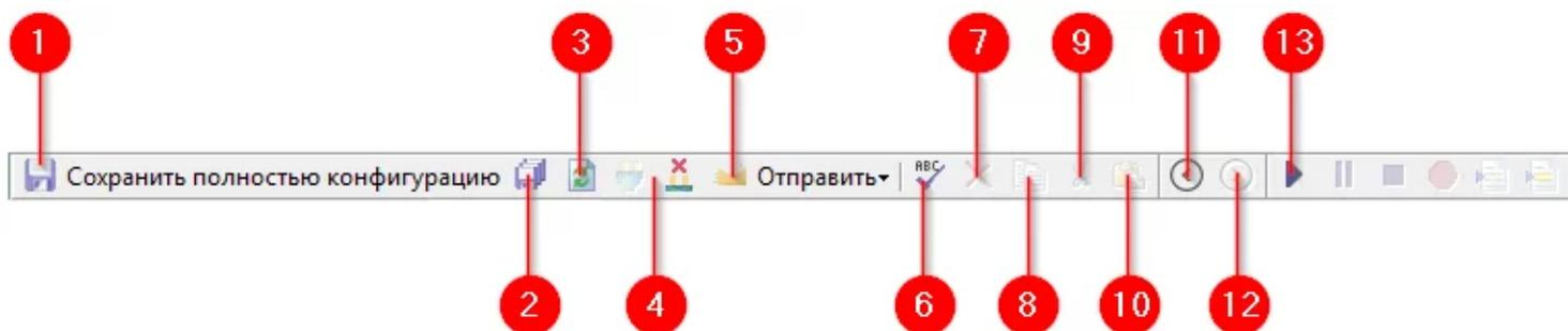
1. Кнопка сохранения отдельного элемента; 2. Сохранить конфигурацию целиком; 3. Обновление конфигурации; 4. Кнопки подключения и отключения от сервера; 5. Кнопка «Отправить»; 6. Проверяет конфигурацию на ошибки; 7. Кнопка «Удалить»; 8. Кнопка «Копировать»; 9. Вырезать выделенный элемент; 10. Вставить ранее скопированный или вырезанный элемент; 11. Возвращает выделение к предыдущему действию в алгоритме; 12. Переводит выделение к следующему действию в алгоритме; 13. Панель управления отладчиком
