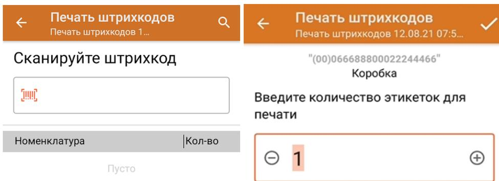
3. Если ранее к вашему ТСД уже был **подключен стационарный/ сетевой принтер**, то после ввода количества сразу начнется печать этикетки. Если нет — начнется поиск доступного для подключения принтера.
