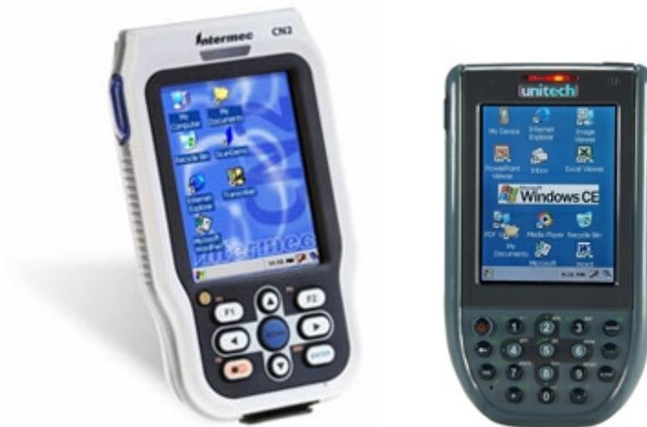
Рис. 4. ТСД с малым числом кнопок (относительные размеры соблюдены)
