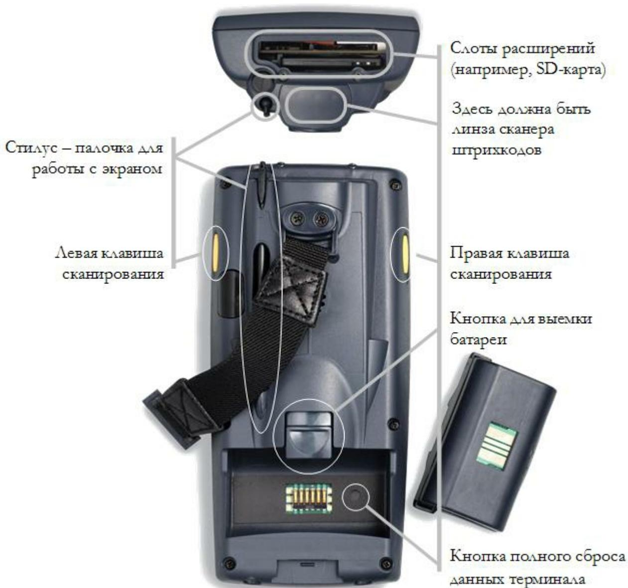
Рис. 3. Дизайн ТСД Intermec 700 (вид сзади)
