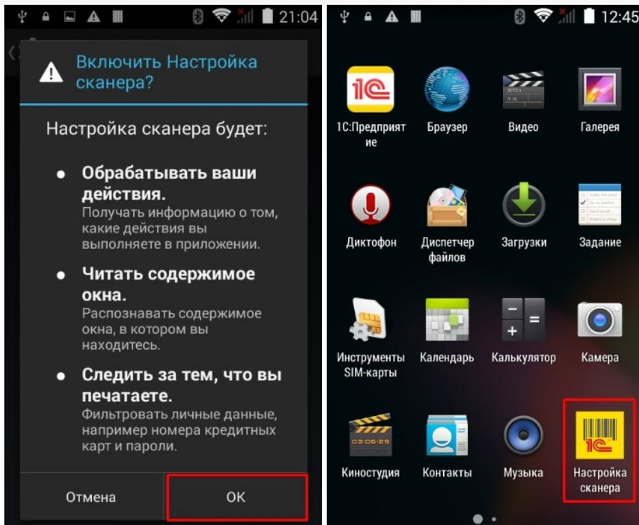
Для некоторых моделей ТСД, чтобы приложение могло работать со встроенным сканером штрихкодов, потребуется установка дополнительного модуля (плагина). В этом случае при запуске будет предложено скачать и установить плагин (если плагин еще не был установлен).
