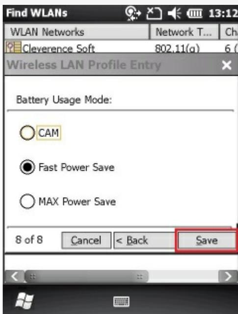
11. Теперь наш профиль для подключения к Wi-Fi точке доступа создан, появится окно с выбором профиля. Экспортируем и сохраняем профиль. Сохранять профиль нужно в папке \Application, ввести произвольное имя профиля латиницей с расширением \*.reg.
