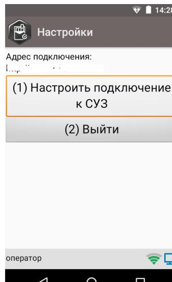
3. Вводим адрес подключения к СУЗ (http://IP: номер порта СУЗ). Это можно сделать как вручную, так и предварительно сгенерировать QR-code с адресом и отсканировать его с помощью сканера ШК.
