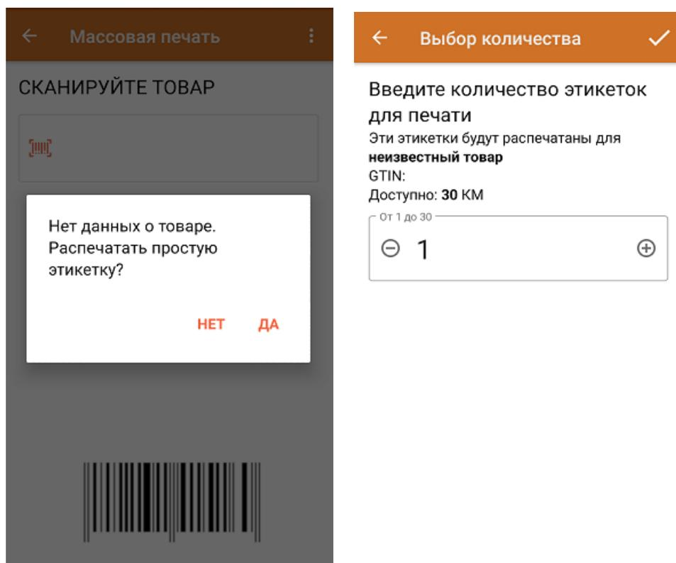
После завершения массовой печати простых этикеток отсканируйте КМ на последней для проверки корректности завершения операции.
