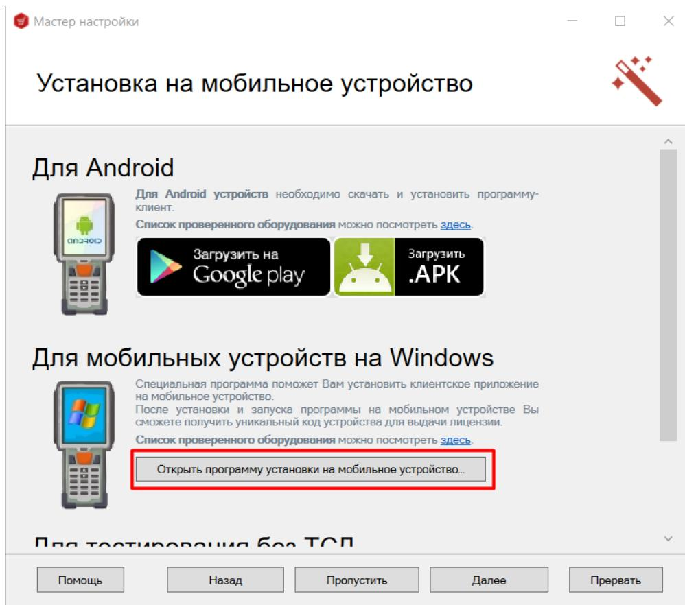
Для установки необходимо подключить ТСД к компьютеру, запустить программу установки клиента на ТСД и следовать инструкциям установщика.
