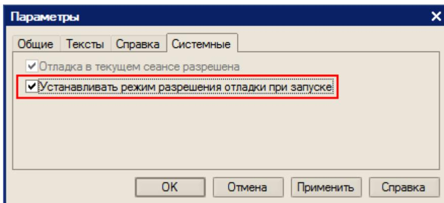
В случае, если флаг «Устанавливать режим разрешения отладки при запуске» не сохраняется, необходимо скопировать файл comcntrcfg.xml (предварительно [скачать и извлечь из архива comcntrcfg.zip](#)) в папки «c:\Program Files\1cv82\8.x.xx.xxx\bin\conf\», «c:\Program Files\1cv82\conf\».
