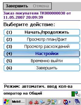
Операции поддерживают два режима ввода количества – «Автоматический» (автоматически учитывает по одной единице товара, или вес, извлеченный из штрихкода) и «Ручной режим» (для самостоятельного ввода количества товара).
