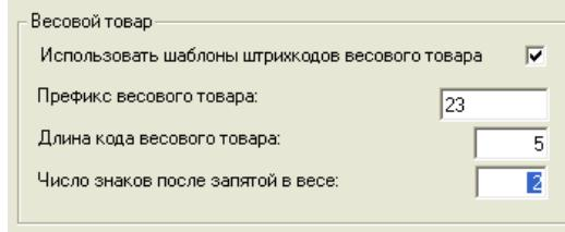
Приведенные настройки означают, что штрихкод начинающийся на «23» относится к весовому товару, следующие 5 знаков в штрихкоде определяют товар (код товара), а в значении веса 2 знака справа составляют дробную часть. Например, в штрихкоде «2312345000452», «23» – префикс, «12345» - код товара, а вес составляет 0.45 кг (последний символ 2 – контрольная сумма штрихкода, значения не имеет).
