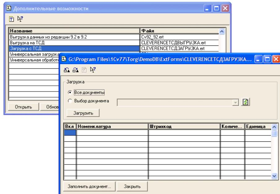
Можно выполнить загрузку всех завершенных на терминале документов или выбрать нужный документ из списка. По кнопке «Загрузить» таблица в нижней половине окна будет заполнена загруженными с терминала данными:
