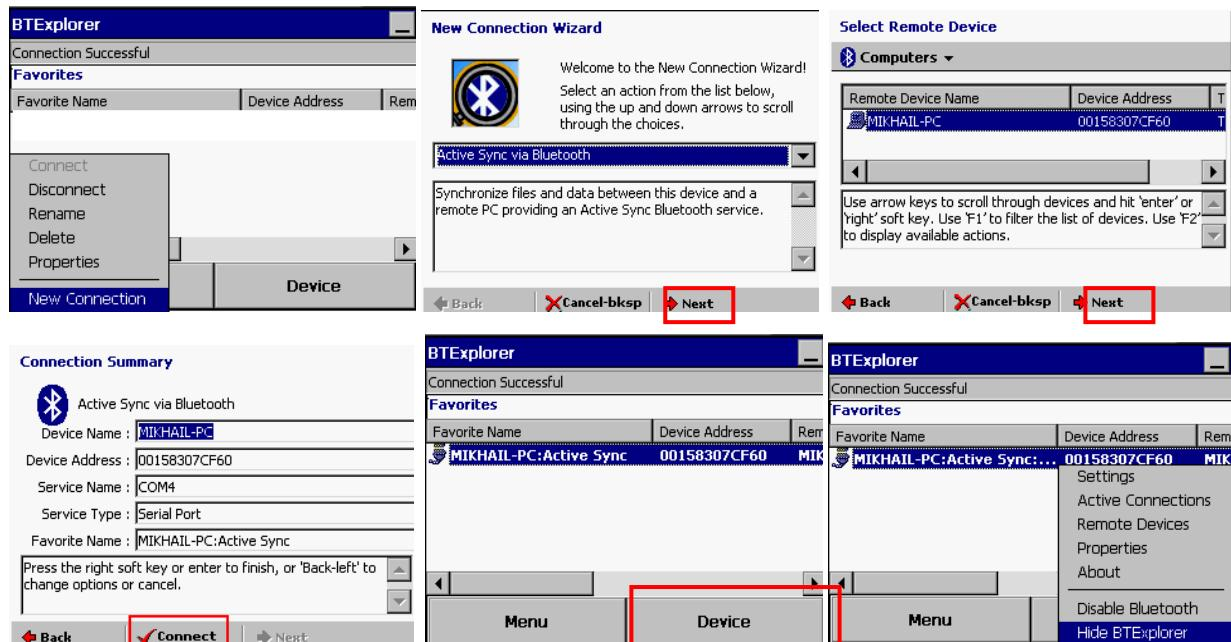
После создания нового подключения «ActiveSync via Bluetooth» в BTExplorer на MC2070, программа драйвера на терминале будет использовать его для автоматического подключения и восстановления связи.
