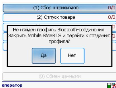
В этом случае для настройки Bluetooth-соединения следует выбрать «Да» и перейти в BTExplorer. Подробно о настройке Bluetooth-соединения в BTExplorer под MT2070 см. в разделе «Особенности работы с моделью Motorola MT2070» в главе про установку драйвера.
