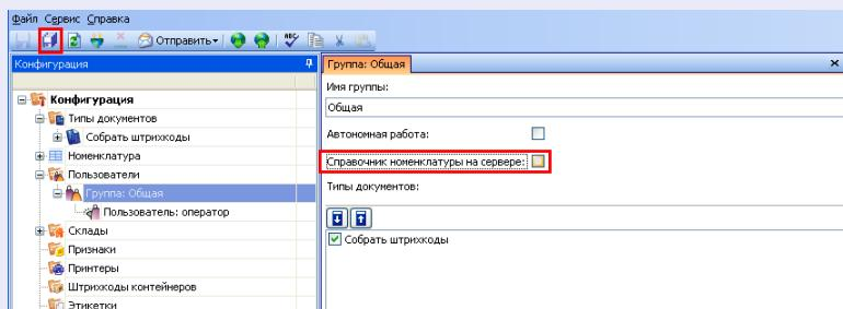
После нажатия «Обмен данными» на ТСД, находящемся в онлайн соединении с сервером терминалов, он закачает с сервера справочник номенклатуры и начнет в этом плане работать независимо. Номенклатура обновляется каждый раз при нажатии «Обмен данными» или автоматическом выполнении обмена данными, например по завершении обработки документа и отправки его на сервер.
