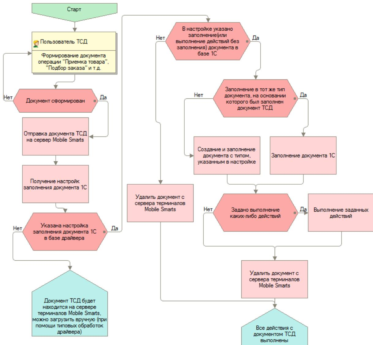
Рис.3.1. Схема работы при заполнении документа в 1С
