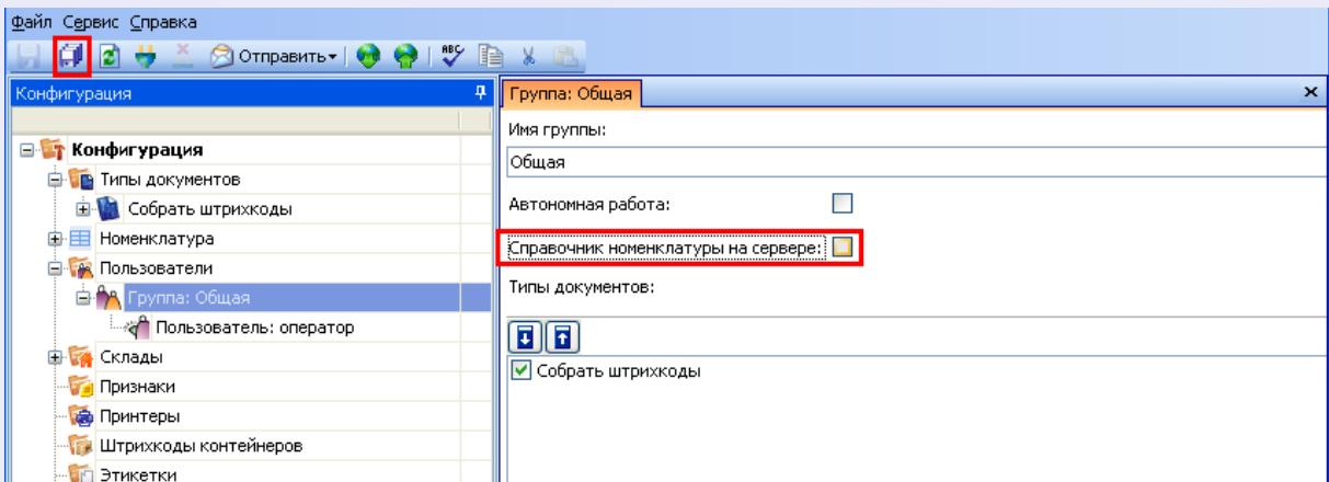
После нажатия «Обмен данными» на ТСД, находящемся в Online соединении с сервером терминалов, он закачает с сервера справочник номенклатуры и начнет в этом плане работать независимо. Номенклатура обновляется каждый раз при нажатии «Обмен данными» или автоматическом выполнении обмена данными, например по завершении обработки документа и отправки его на сервер.
