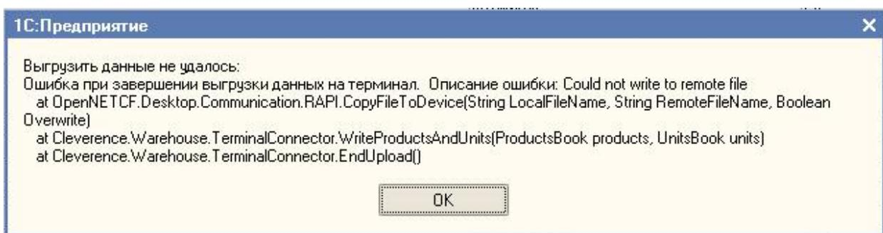
«Слишком большой справочник» по-разному расшифровывается для разного объема памяти терминала. Для терминала с 32Мб памяти (при отсутствии SD-карты и установке в память терминала) слишком большим будет файл в 1Мб или примерно 10000 номенклатур. Для терминала с 64Мб памяти
